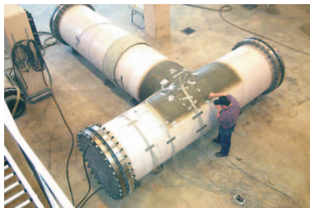
Испытания ламинированного соединения напорного тройника DN 1200/1200, PN 6
